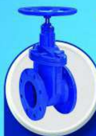
شیر فلکه کشویی زیانه لاستیکی (Rubber Wedge Valve) فشار کاری: PN 10/16 bar وظیفه: قطع و وصل جریان سیال سایز: DN 50 - DN 250
