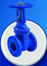
شیر فلکه کشویی بال بهن محور صعودی (Globe Valve) فشار کاری: PN 10/16 bar وظیفه: قطع و وصل جریان سیال سایز: DN 50 - DN 250
